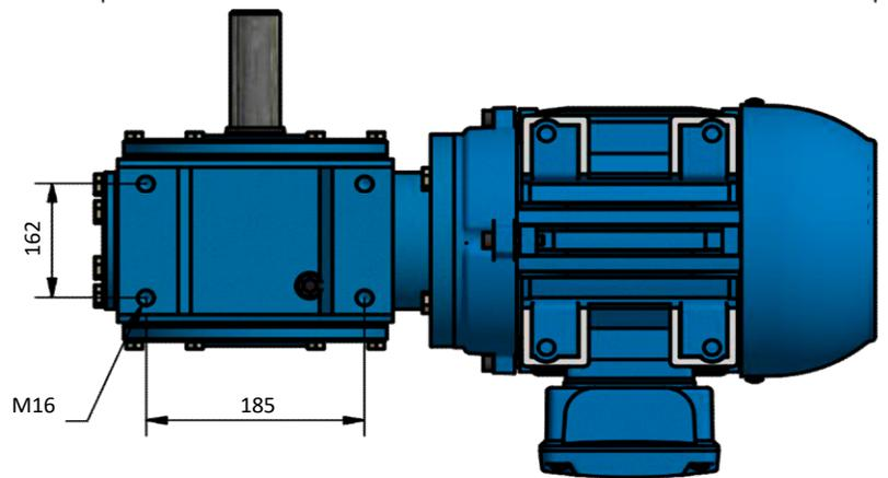
OPÇÃO DO MOTOR COM CAIXA DE LIGAÇÃO ELÉTRICA NO TOPO
