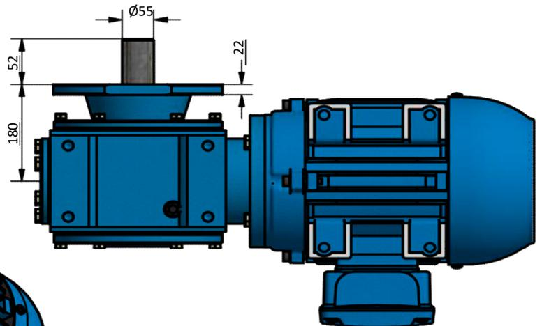
OPÇÃO DO MOTOR COM CAIXA DE LIGAÇÃO ELÉTRICA NO TOPO
