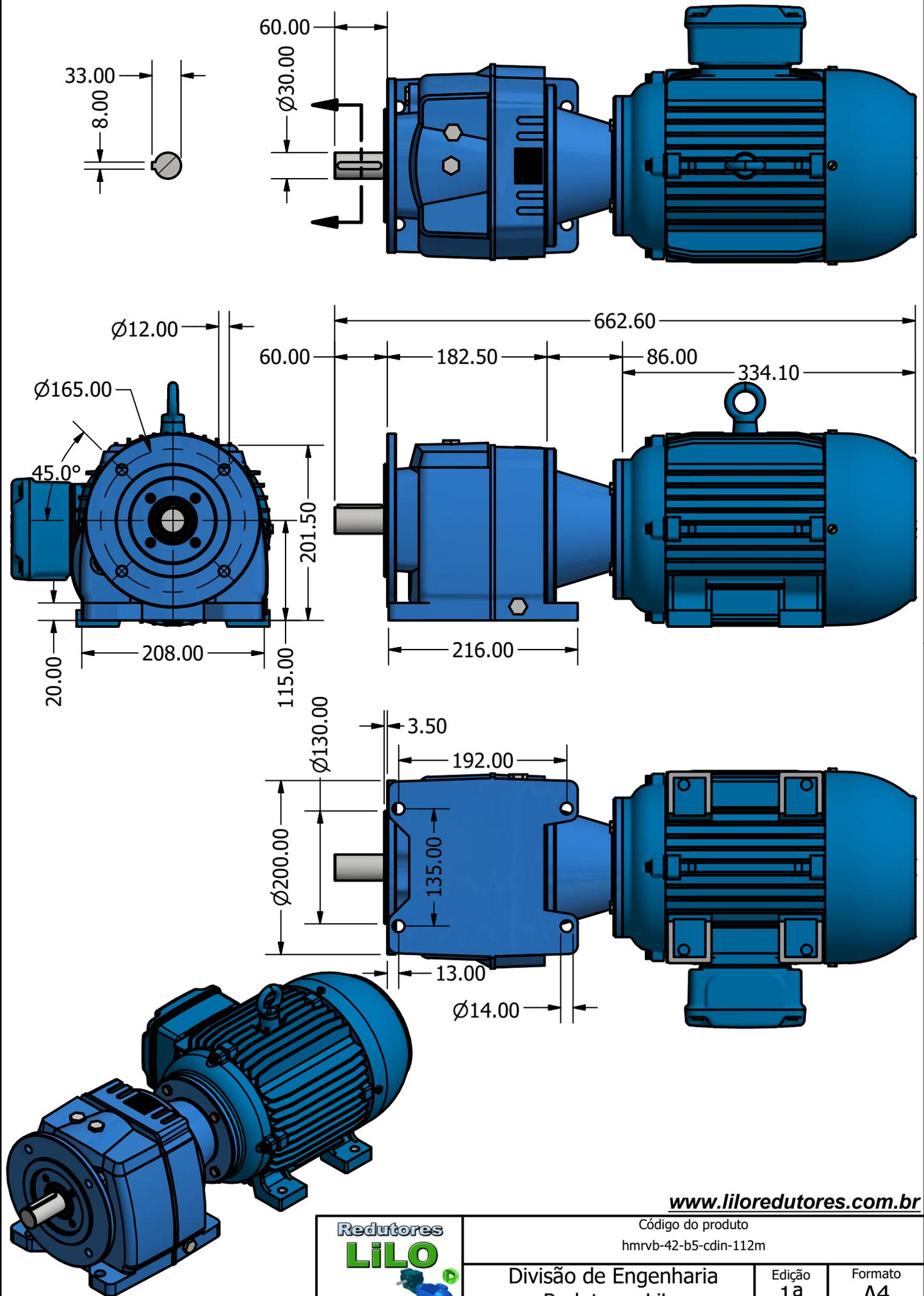
Unidade de medidas em milímetros (mm) - Sujeito a alteração sem aviso prévio
