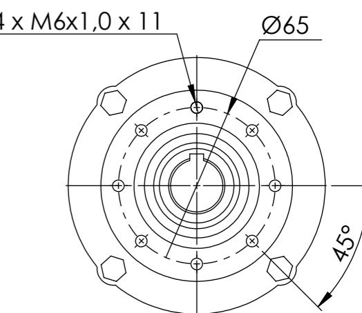
Detalhe da fixação da saída
